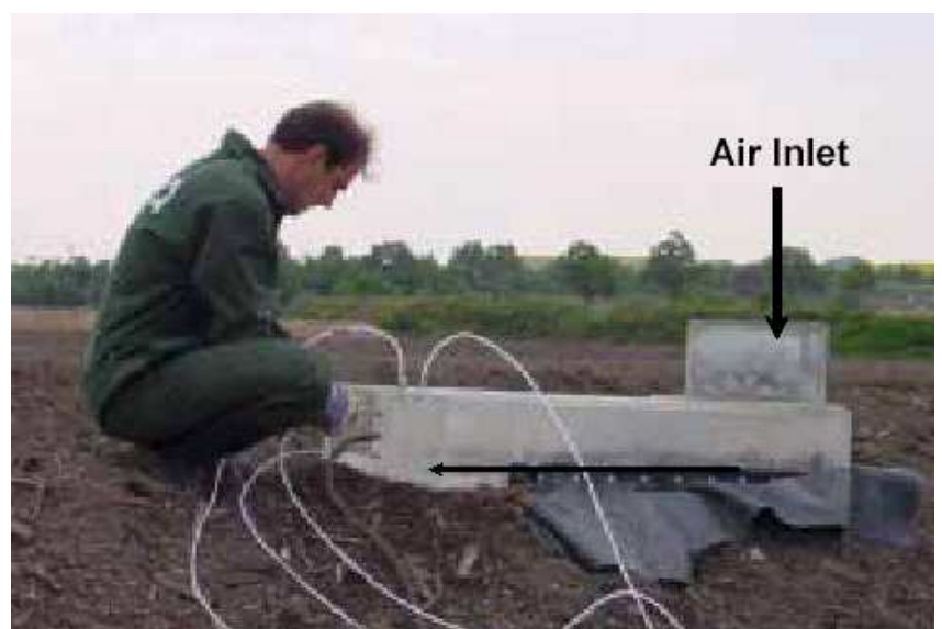
Fig. 4: Prélèvement par boîte de flux (débit de 5 m^3/h )
