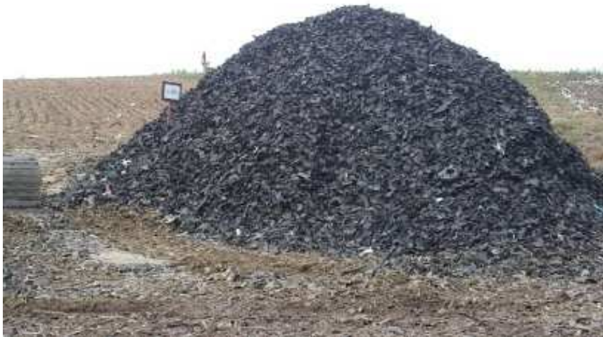
Figure 2 : Tas de "scraps" servant à l'épandage sur les déchets en fin de journée.
