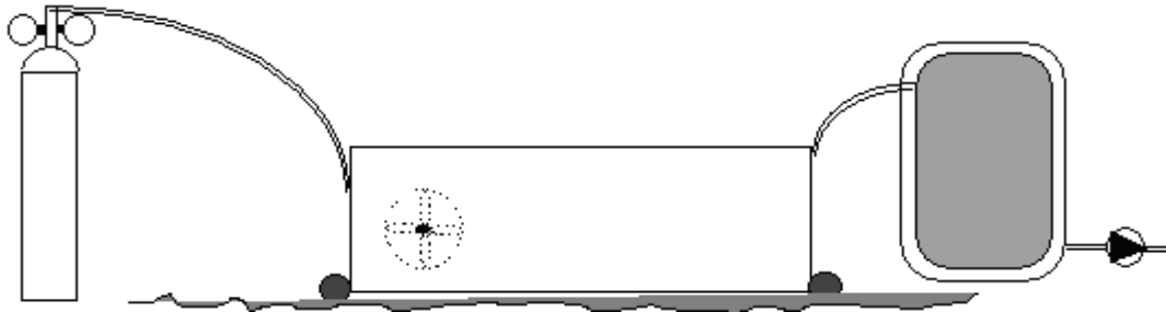
Fig 5 : Principe de la boîte de flux.
