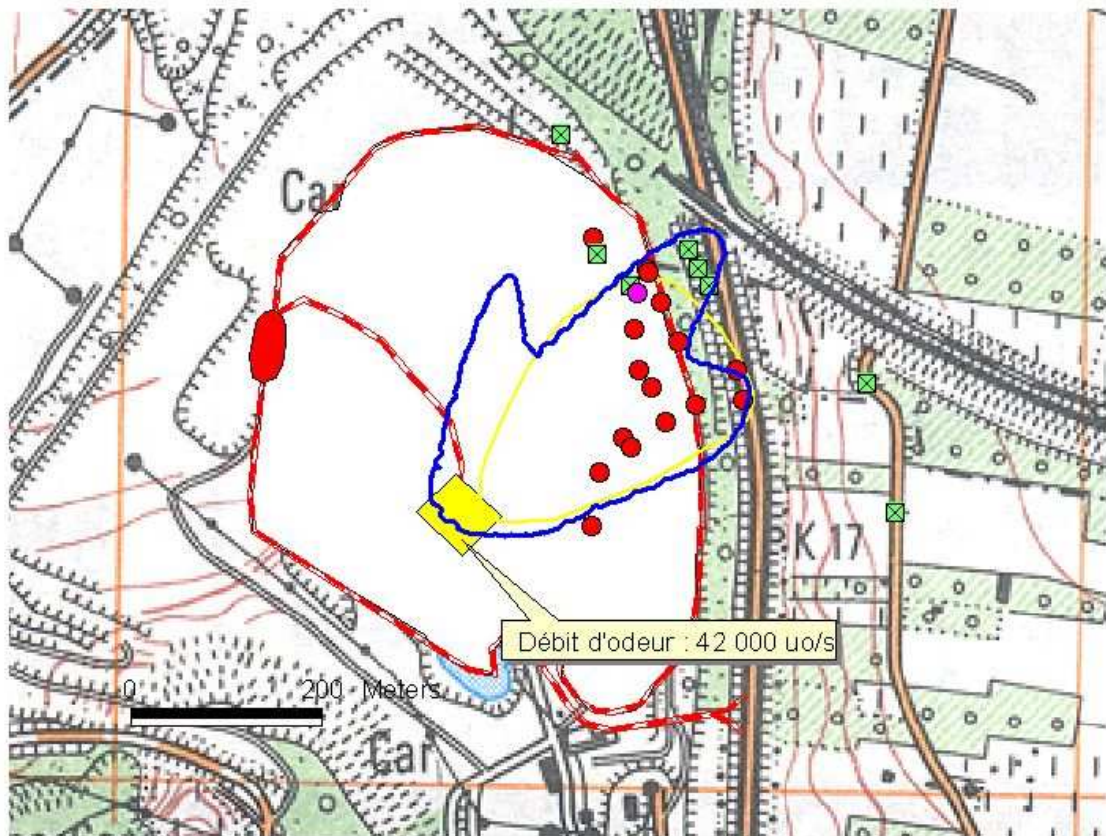
Figure 12 : Courbe limite de perception de l'odeur ajustée par le modèle pour le 12 février 2002
