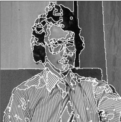
(c) Segmentation complète : étape préliminaire d'un codage par objet.
