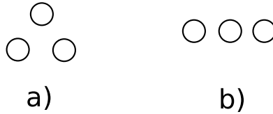
FIGURE 5.9 – Nous avons réalisé des expériences avec 3 billes disposées en triangle (a), ou alignées (b) dans un condensateur plan.
