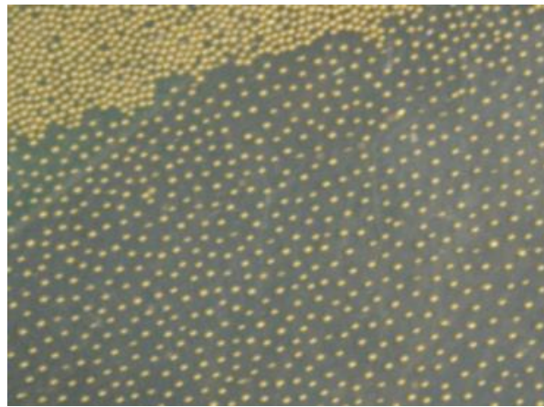
FIGURE 8.2 – Une perspective à ce travail concerne l'étude des cristaux de Wigner. En les plaçant sur l'électrode inférieure d'un condensateur plan, des billes conductrices peuvent se charger du même signe et subir une interaction répulsive. On observe la formation d'un cristal de Wigner.
