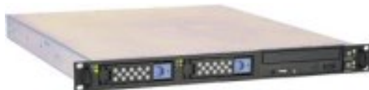
Voici ce qu'est un rack 1 U. A éviter !
