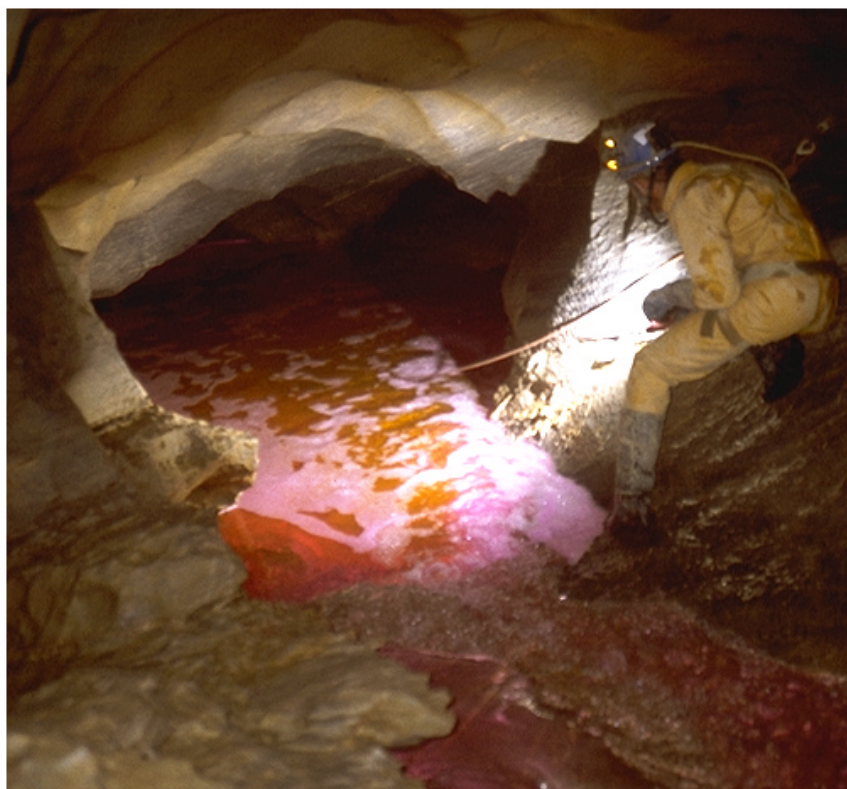
Figure 13 : Colorant de traçage dans une rivière souterraine (photo : P. Meus).
