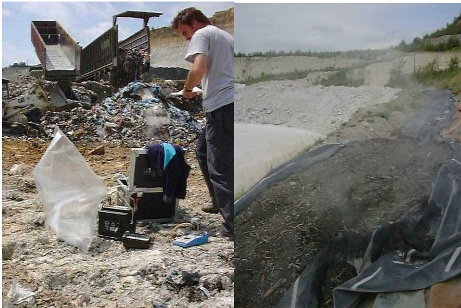
Photos 2.8 et 2.9 : Conditions de mesure des odeurs aux alentours des déchets frais et des mâchefers
