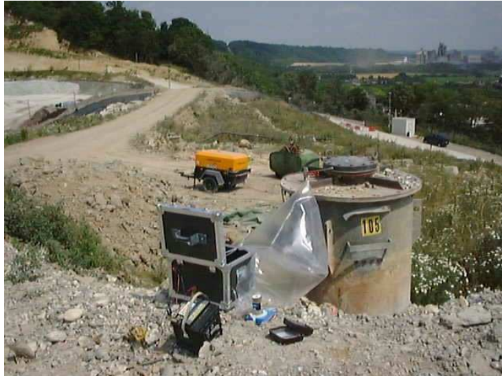
Photo 2.10 : Conditions de mesure des odeurs à proximité des puits de biogaz
