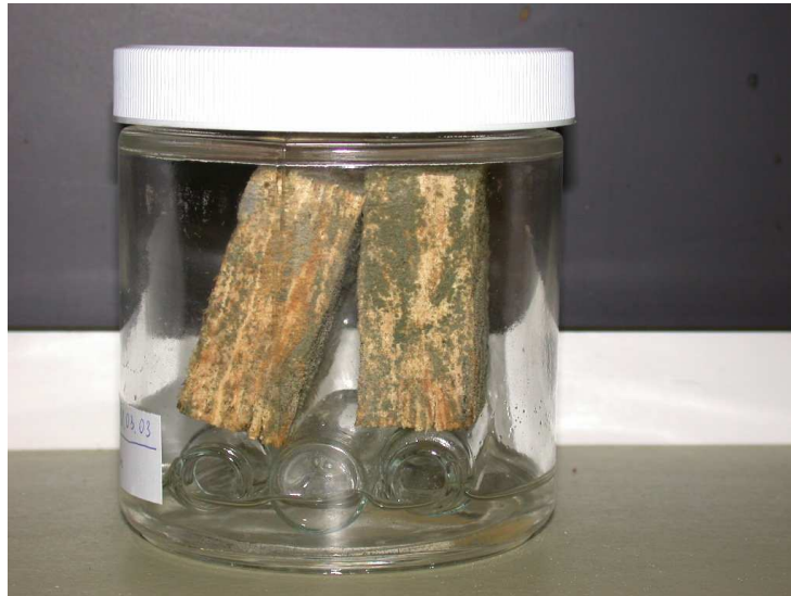
Photo 3 : Récipient utilisé pour incuber les échantillons (stade avancé de développement des moisissures sur les échantillons de panneau OSB)
