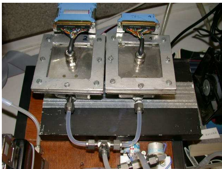
Photo 7 : Les enceintes contenant les capteurs connectées à l'unité d'échantillonnage
