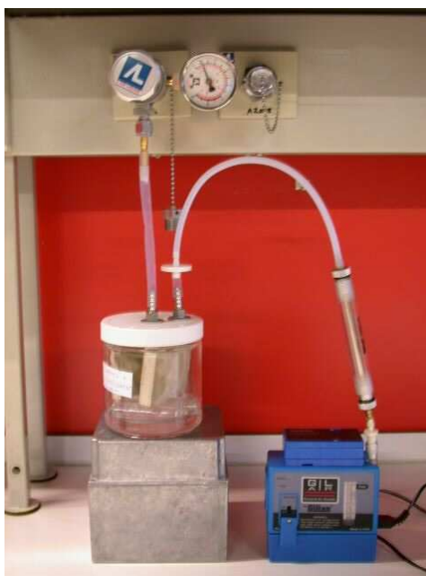
Photo 4 : Prélèvement d'air pour les analyses chromatographiques
