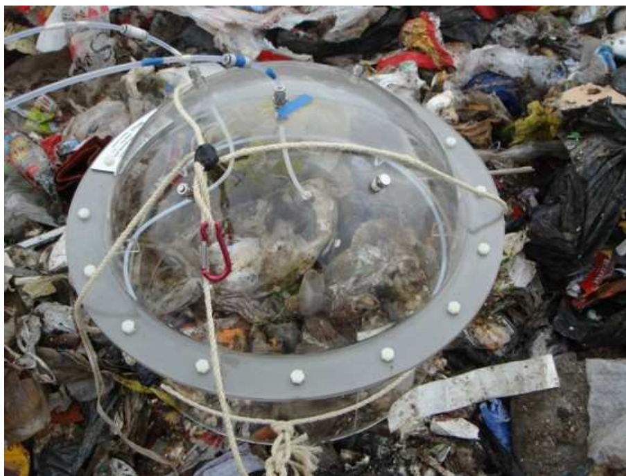
Figure 20 : Vue rapprochée de la chambre de flux déposée sur la surface de déchets à Malvoisin
