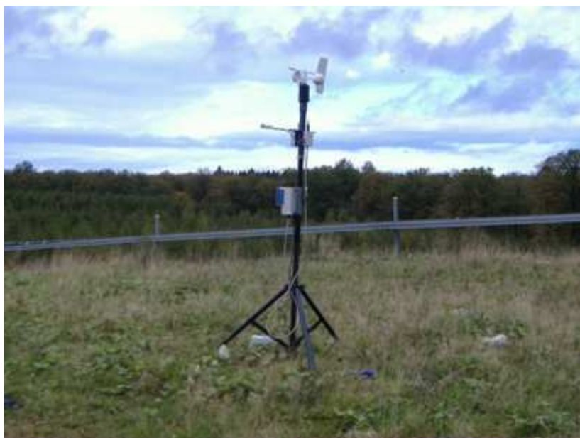
Figure 9 : Station météo mobile placée sur un point haut du site
