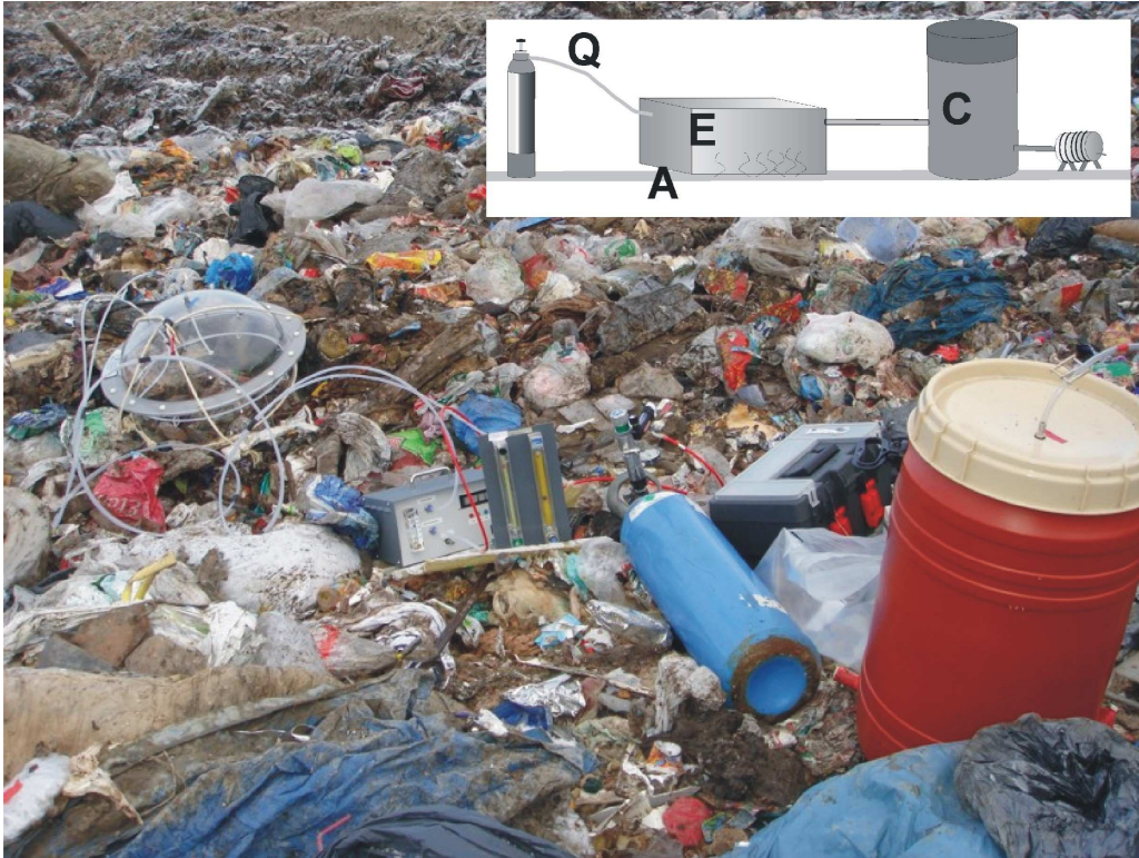
Figure 1 : Prélèvement par chambre de flux sur une surface de déchets
