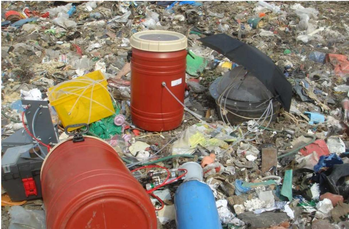
**Figure 30 : Prélèvement par chambre de flux sur la surface de déchets fraîchement déversés**
