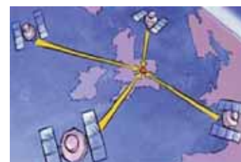
Pour déterminer sa position, un récepteur GNSS doit utiliser les signaux en provenance d'au moins quatre satellites. © Thales Alenia Space
