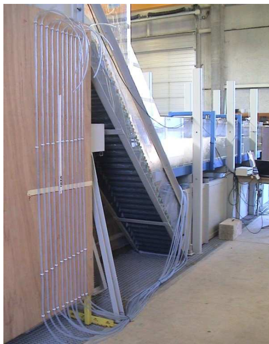
Figure 23 : panneau vertical regroupant les onze prises de pression statique.
