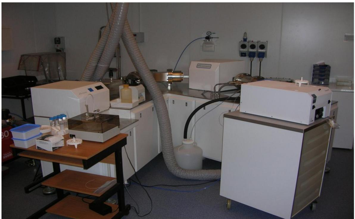
Figure 9.B : Un MC-ICP-MS Nu Plasma de l'ULB (source : N. Mattielli).
