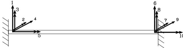
FIGURE 8.1. NUMÉROTATION DES DEGRÉS DE LIBERTÉ DE L'ÉLÉMENT FINI
