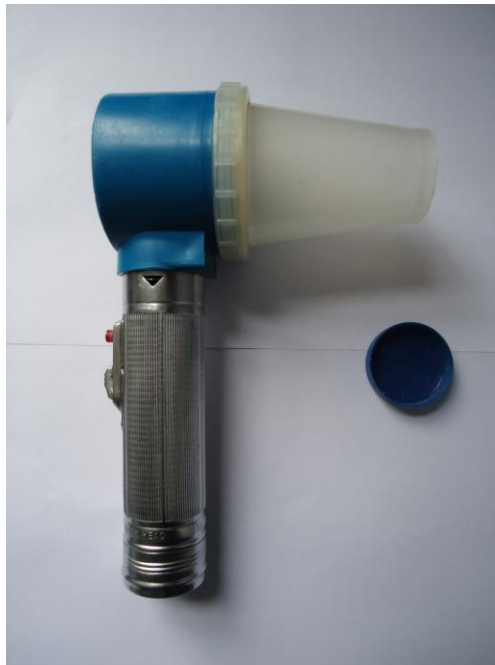
Figure 6: Aspirateur utilisé pour capturer les insectes auxiliaires aphidiphages parasitoïdes sur plante.
