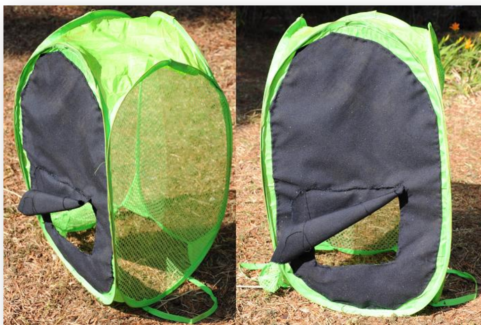
Figure 8 : Cube de comptage : vues sur la face opacifiée, son entrée, et sur les faces lumineuses.
