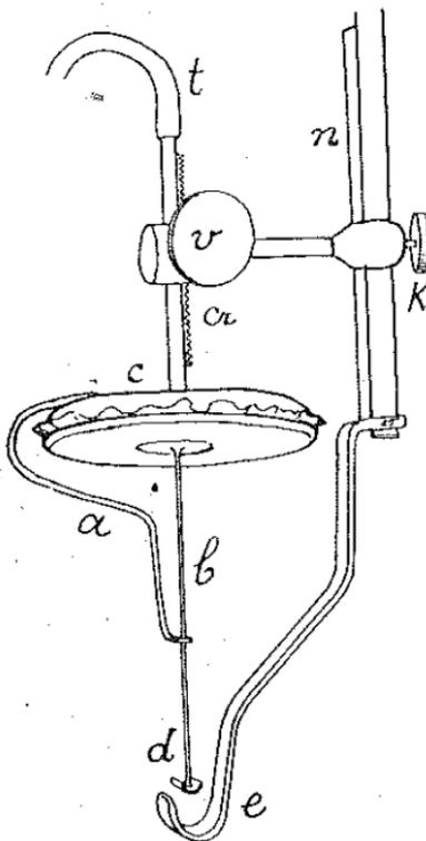
FIG. 3. — Tambour explorateur du sphygmographe à transmission. L'artère se place entre *d* et *e*. (Voir PHILIPS dans *Arch. intern. physiol.*, 1904, t. I, p. 81, fig. 2.)
