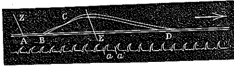
Fig. 1. Graphiques de secousse musculaire. Centièmes de seconde. Myographe à poids. Vitesse maximum du cylindre. AB période d'énergie latente; BC période d'énergie croissante; CD période d'énergie décroissante.
