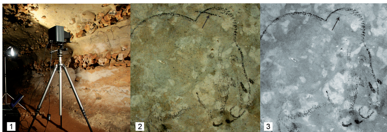
Figure 3 - 1 : Système de réflectographie infrarouge mis en œuvre à Rouffignac. Comparaison entre une photographie du mammoth 66 (2) et son image en réflectographie infrarouge (3). On constate que le trait traversant au niveau de la tête, et identifié comme étant du noir de carbone par spectrométrie Raman, apparaît en plus clair que le reste du dessin dont les traits sont composés d'oxyde de manganèse.
