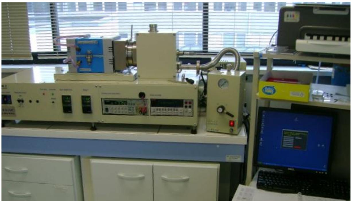
*Figure 1 : dispositif de mesure en température de la résistivité électrique et du coefficient Seebeck des matériaux ULVAC-RIKO ZEM-3*
