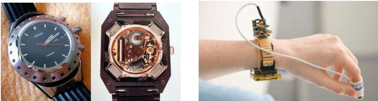
Figure 5 : montre et appareil médical (oxymètre à pouls) alimentés par des dispositifs thermoélectriques
