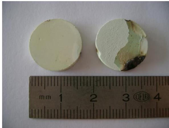
*Figure 32 : photographie de pastilles de composition  $In_{1.99}Ge_{0.01}O_3$  ( $\varnothing = 16$  mm) à cru et à l'issue du frittage micro-ondes en configuration directe*
