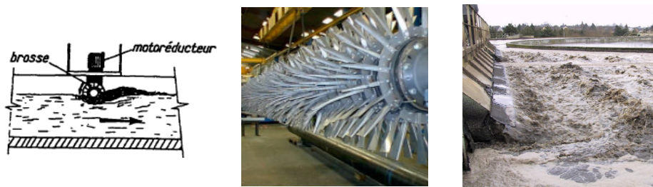
Figure 11 : aérateur de surface à axe horizontal a vitesse lente (Gillot 2003)
