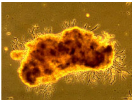
Figure 3 : photographie d'un floc, les masses noires sont dues à des concentrations élevées de bactéries. On observe un léger développement de bactéries filamenteuses sur le pourtour du floc qui ne vont pas nuire à sa décantation (Spencer Davies P. 2006).
