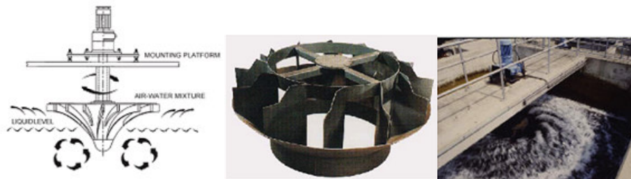
Figure 10 : aérateur de surface a axe vertical a vitesse lente (Thonart 2006)
