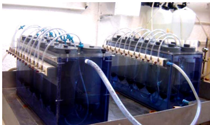
Figure 2-4 : Système de mini-réacteurs utilisés pour les expériences d'une durée de 5 jours.
