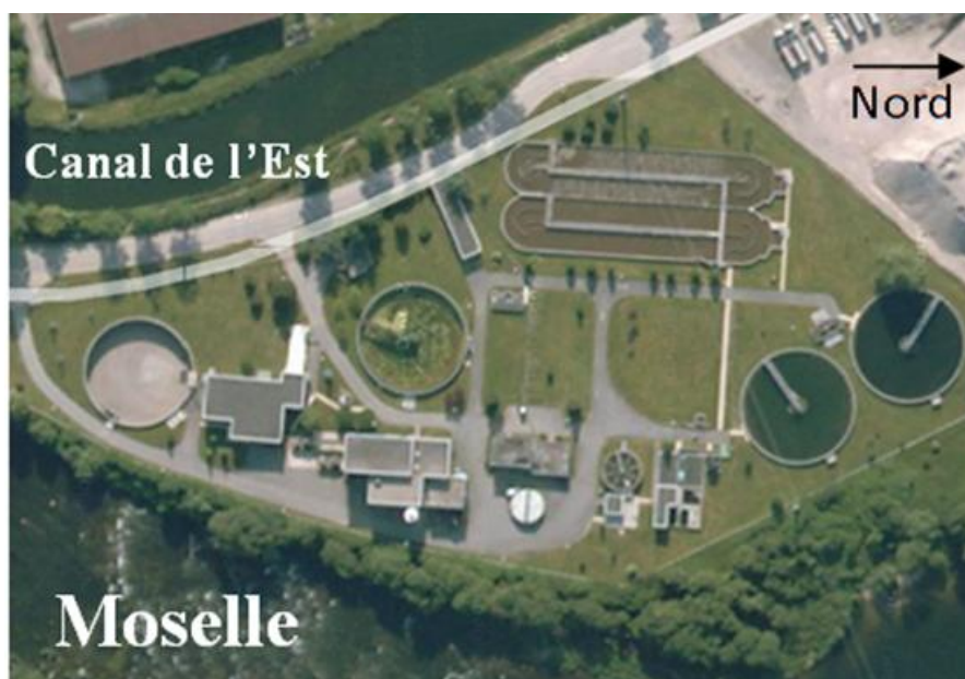
Figure 2-2 : La station d'épuration d'Epinal dont les rejets s'effectuent dans la Moselle. Les deux lignes de traitements sont visibles (2 chenaux d'oxydation et 2 clarificateurs). (D'après une image satellite google map)
