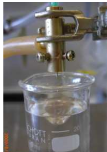
Figure V-3 : Générateur de gouttes à courant d'air coaxial mis à disposition par le Centre Interfacultaire des Biomatériaux (gauche) : photo montrant la solution de \text{CaCl}_2 et le générateur au centre duquel se trouve l'aiguille de la seringue contenant la solution de Na-Alginate (droite) : schéma de principe du générateur montrant comment l'air est injecté dans le cylindre creux et favorise le détachement des gouttes.
