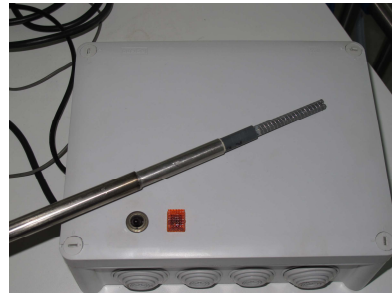
Figure IV-2 : Sonde de conductimétrie « maison ».
