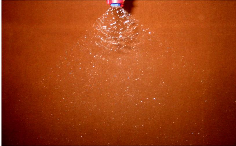
Figure 3.6. : Jet issu de la buse XR11003VK pulvérisant à 2 bar.
