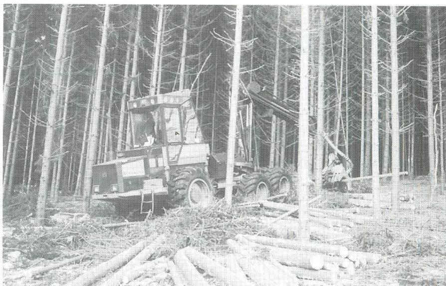
Abattage, ébranchage et façonnage sont effectués par la même machine.
