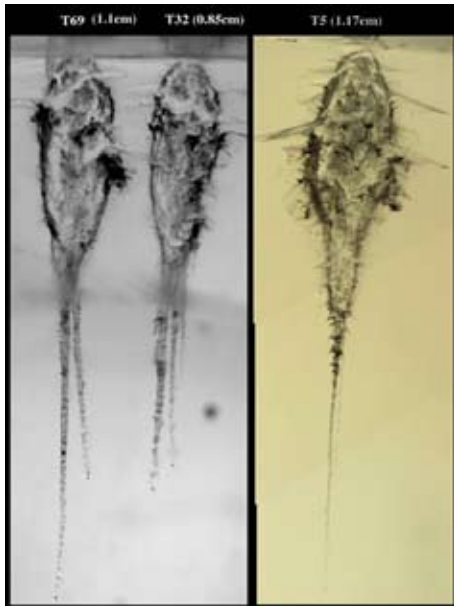
Traces d'impacts de particules cométaires dans l'aérogel de Stardust. (© NASA/JPL)
