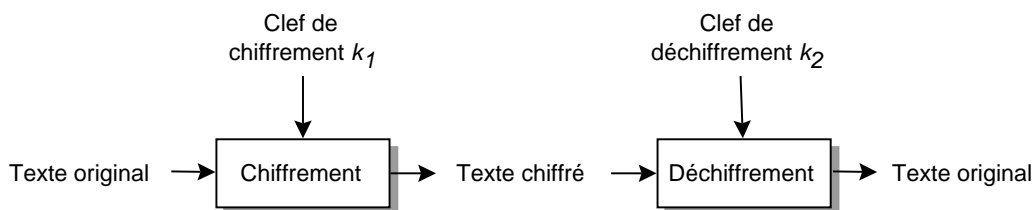
FIG. 3.2 – Chiffrement et déchiffrement avec deux clefs distinctes.
