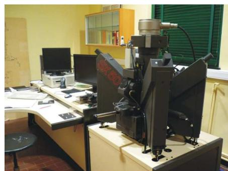
Fig. III.5. Microsonde CAMECA modèle SX50 équipée de quatre spectromètres WDS.
