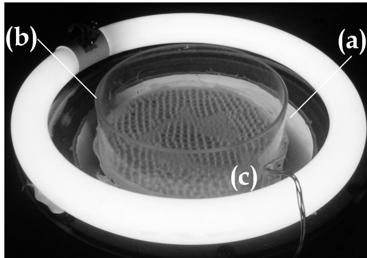
FIG. 9.2 – Dispositif vibrant : (a) plaque de cuivre; (b) cylindre en plexiglas; (c) sonde de l'accéléromètre.
