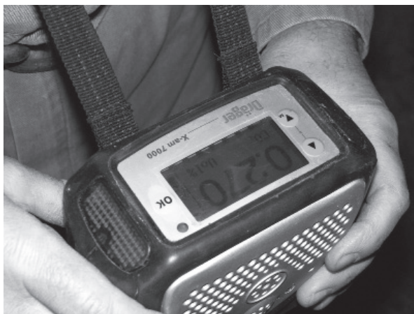
Fig. 5. – L'analyseur à infra-rouge portatif à lecture directe Dräger X-am 7000
