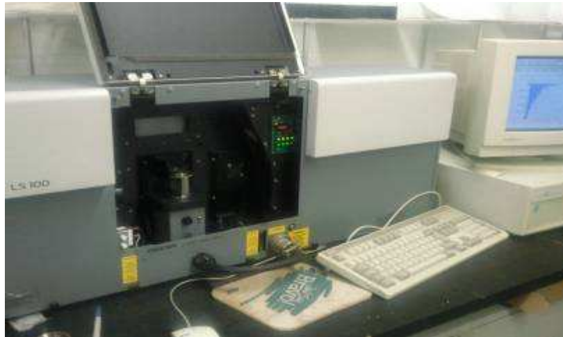
Figure V-1 : Photographie du Granulomètre Laser Coulter LS 100
