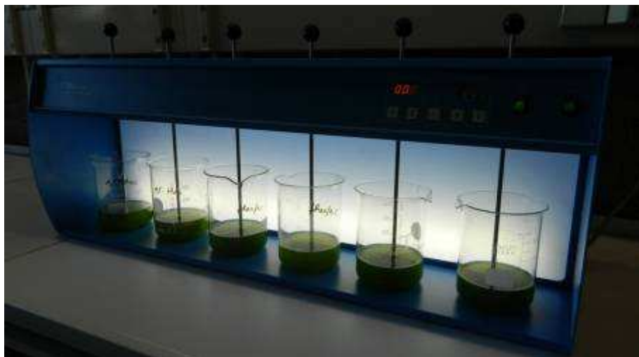
Figure V-2 : Photographie d'essais d'autofloculation en jar-tests
