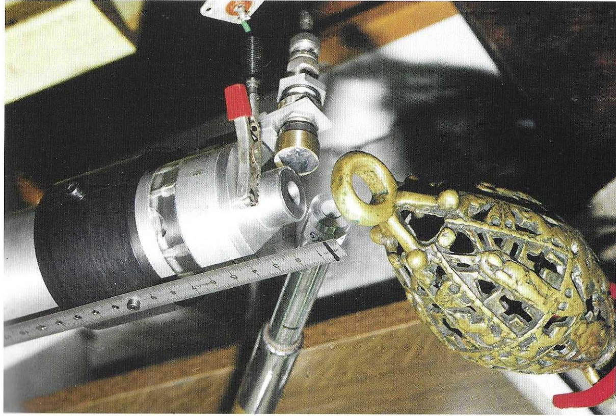
La clé de saint Hubert sous le faisceau du cyclotron de l'Université de Liège.
