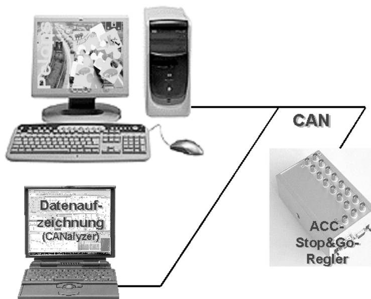
Bild 7: Struktur der Simulationsumgebung Structure of the simulation environment
