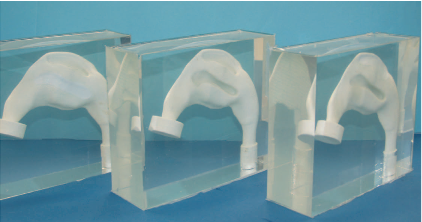
Bild 2: Nasenmodelle aus Silikon für reale Strömungsexperimente.
