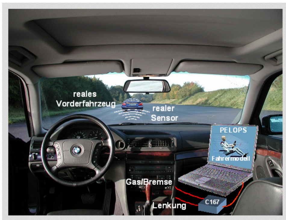
Bild 7: PELOPS Fahrermodell als Regler im Versuchsfahrzeug
