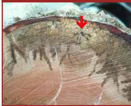
FIGURE 6 – SECTION TRANSVERSALE DANS DU BOIS DE HÊTRE INOCULÉ AVEC F. PINICOLA MONTRANT LES CELLULES INFECTÉES BRUNIES SUITE À L'ACCUMULATION DE POLYPHÉNOLS
