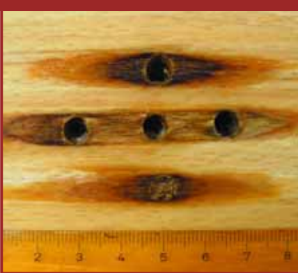
FIGURE 5 – SECTION TANGENTIELLE DANS UN TRONC DE HÊTRE INOCULÉ AVEC F. PINICOLA MONTRANT L'ÉTENDUE DES DÉGRADATIONS APRÈS 6 MOIS D'INCUBATION
