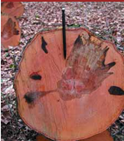
FIGURE 10 – ASPECT EN AVRIL 2003 DES PIQÛRES DE TRYPDENDRON SP. DATANT DE 2001 (COLORATION NOIRÂTRE) ET DE PIQÛRES PLUS ANCIENNES LOCALISÉES DANS UNE ZONE DE BOIS ALTÉRÉ EN ORIENTATION NORD-EST, À L'APLOMB D'UNE LÉSION CORTICALE
